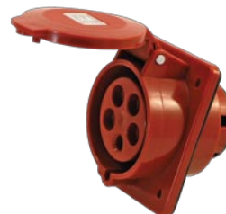
Розетка прямая стационарная защищенная внутренняя 3P+PE+N 380В IP44
