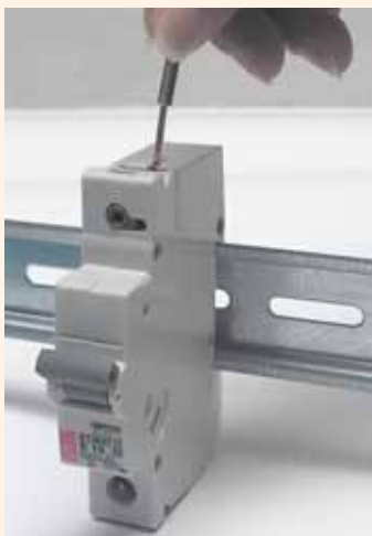
Izmantot cietu vadu ar šķērsgriezumu no 1,5 līdz 4 mm 2
