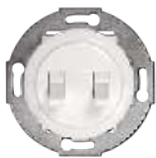
Выключатель скрытой установки двухрыжковый Напряжение 250 В Ток 10-16 А Габариты R70 x 37 мм
