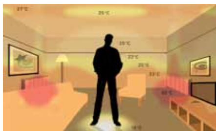
Telpas temperatūra, ja neizmantojama grīdas apsildes sistēma. Telpā jūtamas lielas temperatūras svārstības (18 - 65°C).
