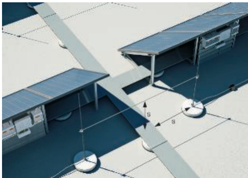
1. attēls: Atstarpes attālums (s) starp zibensaizsardzības iekārtu un kabelus nesošo sistēmu
