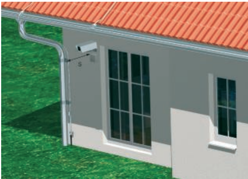
Atbilstoši noteikumiem ievērots atstarpes attālums (s) starp novadišanas iekārtu un kameru
